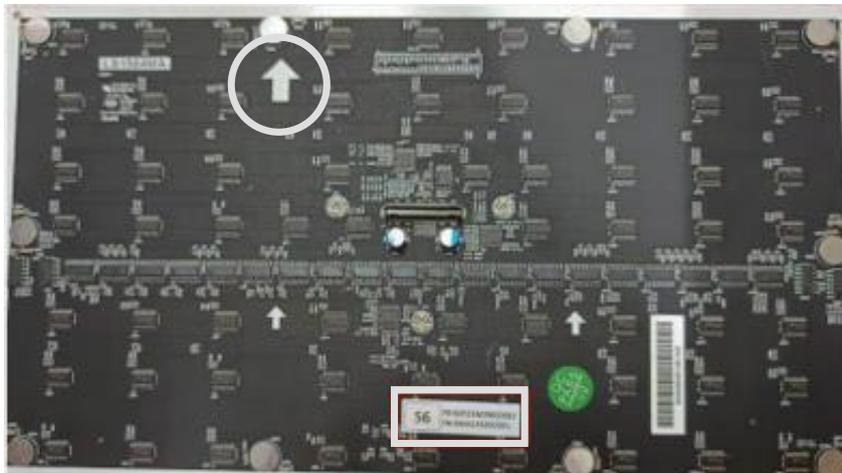
2. Bringen Sie die verbleibenden LED-Module an den Gehäusen an. Beginnen Sie bei der Installation oben links und fahren Sie mit unten rechts fort. Achten Sie darauf, die entsprechenden Nummern am Modul mit dem Gehäuse abzugleichen.
